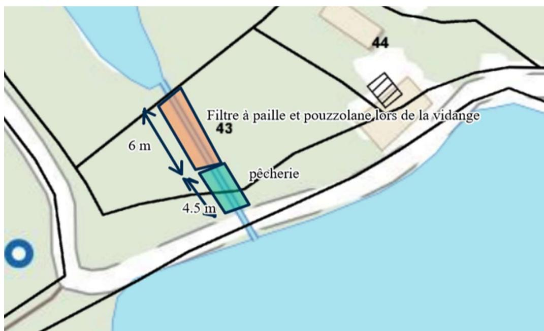
*Dispositif type de filtration mis en œuvre lors d'une vidange (schéma non contractuel)*
