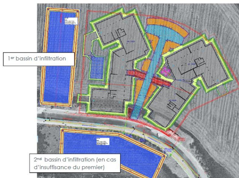
Figure 13 : Implantation des bassins temporaires d'infiltration (source : PENNEQUIN)- sans échelle
